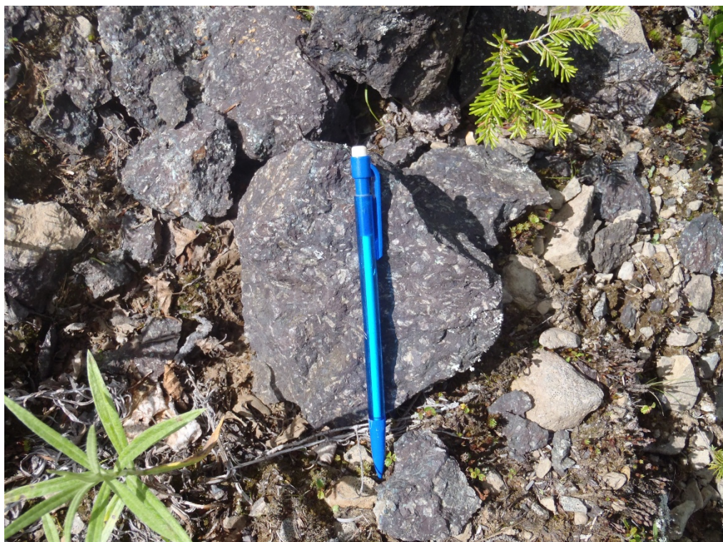
Figure 25 : Échantillon 12961, 1870 ppm de Cu Basalte hématisé à phénocristaux feldspath épidotisés
