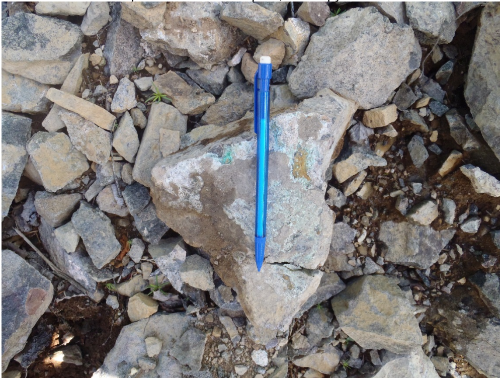
Figure 27 : Échantillon 12979, 2900 ppm de Cu Basalte à phénocristaux feldspath, chalcopyrite disséminée
