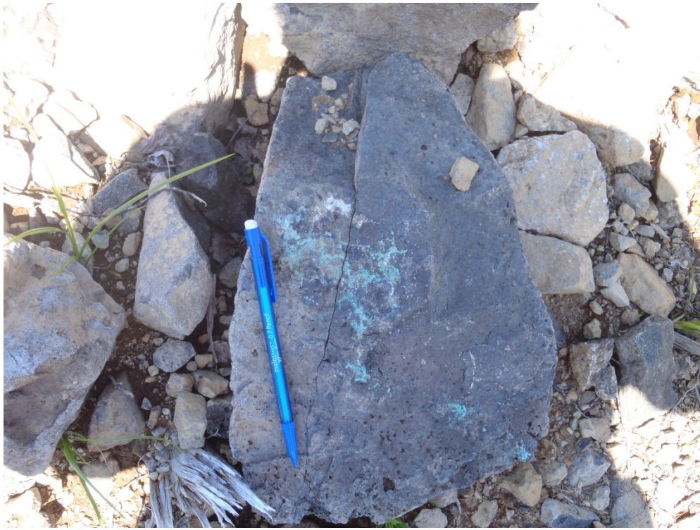
Figure 27 : Échantillon 12979, 2900 ppm de Cu Basalte à phénocristaux feldspath, chalcopyrite disséminée
