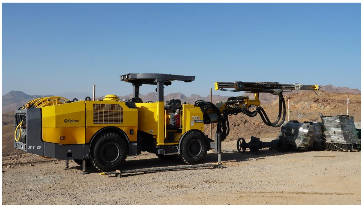
Figure 2 : Mobilisation d'une foreuse frontale à Zgounder
