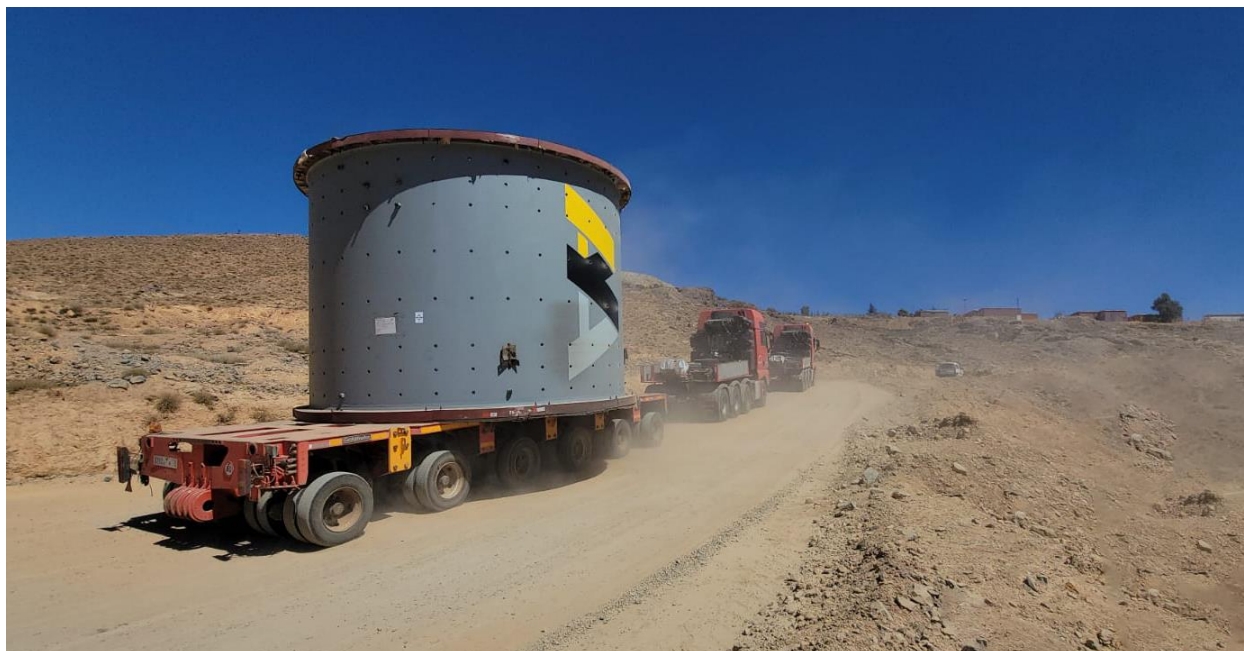
Figure 1 : Livraison du broyeur à boulets sur le site de la mine Zgounder
